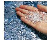
熱処理ガラスの割れた場合
